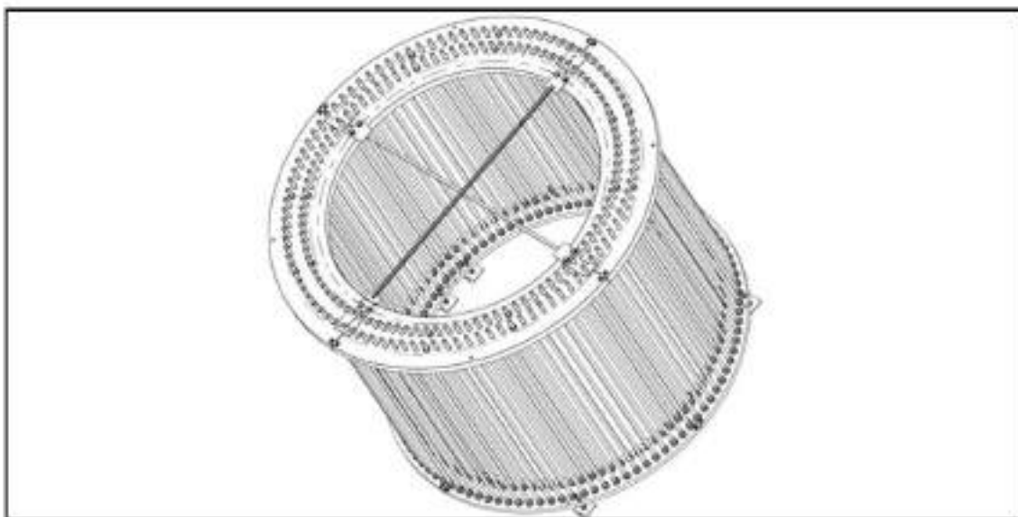
Figure 4. Gabbia di ancoraggio
